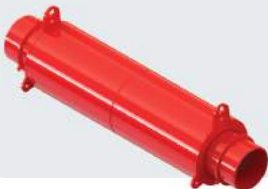
**ДВУХСЕКЦИОННОЕ СИЛЬФОННОЕ КОМПЕНСИРУЮЩЕЕ УСТРОЙСТВО С ТЕПЛОИЗОЛЯЦИЕЙ СИЛЬФОНА** снабжено теплоизолированными многослойными сильфонами из нержавеющей стали, патрубками под приварку и защитными кожухами, направляющими для предотвращения торсионных вращений и шайбами для дополнительной установки механизмов предварительного растяжения. В изделии предусмотрены проушины для подъема и предварительного растяжения (Таблица 6).
